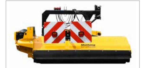
Plaques de signalisation pivotantes avec dispositifs d'éclairage et supports d'éclairage à fixation robuste sans éléments mobiles
