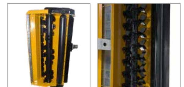
Les lames de manille « M » en carbure robustes à visser et le rouleau palpeur suiveur continu assurent une coupe parfaite. Des couteaux en Y à 2 lames silencieuses sont disponibles en option.
