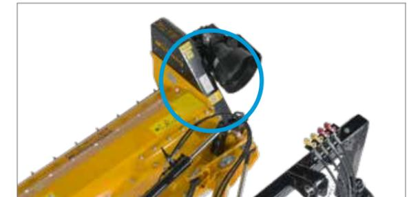
Tension des courroies trapézoïdales toujours facilement vérifiable : protection de courroie trapézoïdale avec orifice de contrôle.
