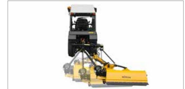
Une grande zone de portée permet de travailler tant à l'arrière que sur le côté du tracteur. Permet d'intervenir sur les voies d'accès étroites comme sur les accotements.
