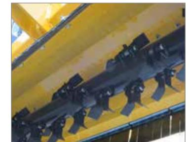
Grâce aux lames spéciales en Y montées sur le rotor à une hauteur de travail variable jusqu'à environ 11 cm, l'effet d'aspiration est moindre, ce qui permet aux reptiles et aux petits organismes de rester sur le sol et de ne pas entrer en contact avec les lames en Y.
