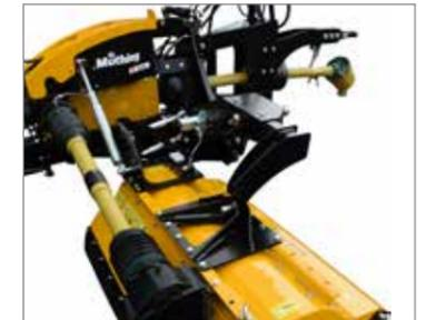
La suspension à bielles des deux broyeurs à montage latéral permet de suivre aisément les contours tout en conservant une hauteur de coupe constante.
