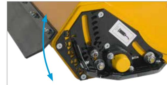
Réglage rapide de la hauteur de coupe à l'aide d'un seul outil : desserrer le raccord à vis / ajuster la hauteur de coupe / serrer le raccord à vis.
