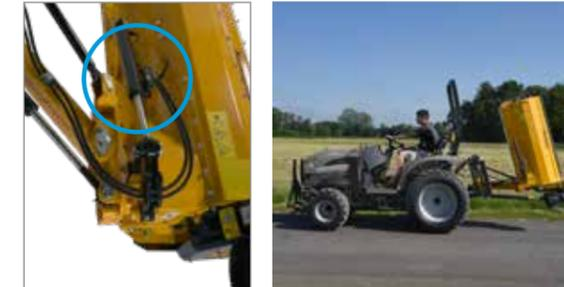
Verrouillage de transport de sécurité pour la conduite sur route ou lors du transport de l'attelage avec une remorque de véhicule léger.
