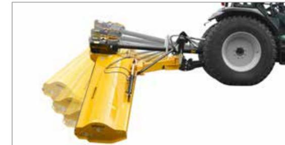
La sécurité anti-collision mécanique brevetée se déclenche de manière fiable et revient d'elle-même en position de travail.
