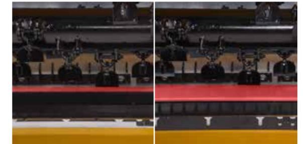
Le MU-Vario® se caractérise par une forme optimisée de l'admission et du carter, et un degré de broyage et de défibrage à réglage progressif. Pour une qualité de broyage et de défibrage idéale.
