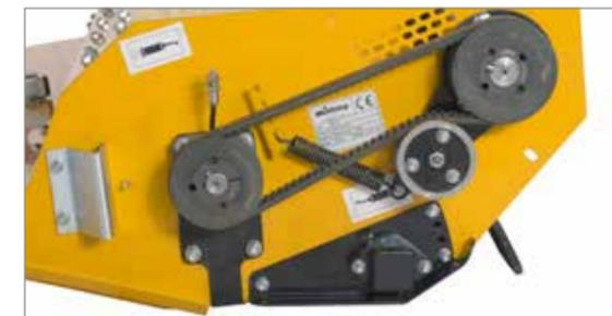
Travail sans encombre et nécessitant peu d'entretien grâce au tendeur automatique de courroie.
