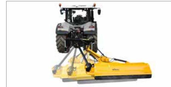
Une grande plage de pivotement permet de travailler tant à l'arrière que sur le côté du tracteur. Permet d'intervenir sur les voies d'accès étroites comme en bordure de champ.
