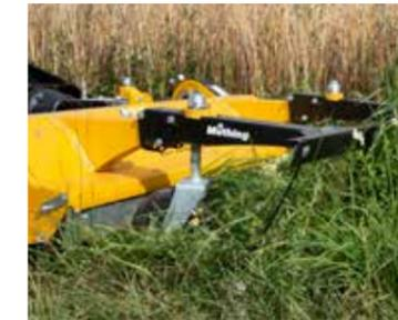
Sauveteur d'insectes de série monté à l'avant.
