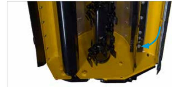
Le clapet de coupe courte peut être rapidement rabattu vers le bas manuellement pour un résultat de coupe propre.
