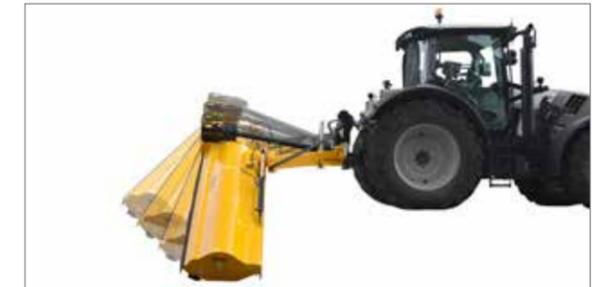
La sécurité anti-collision mécanique brevetée se déclenche de manière fiable et revient d'elle-même en position de travail.
