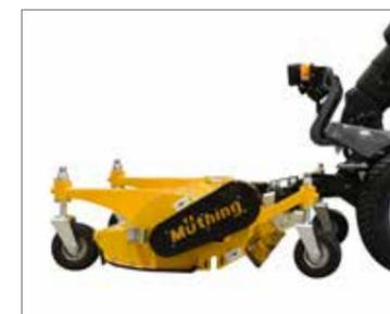
Les roues de support avant de série facilitent la manipulation et améliorent le suivi du sol. Elles sont réglables en hauteur et pivotantes à 360°, en option disponibles en tant que roues d'appui arrière au lieu du rouleau d'appui.
