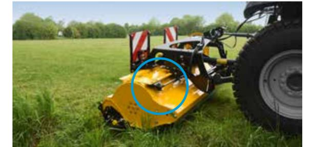
Déport latéral hydraulique : broyage déporté à côté du tracteur pour plus de flexibilité autour des arbres, des entrées ou autres obstacles (en option).
