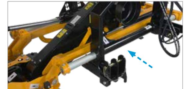
La sécurité anti-collision mécanique protège le broyeur des dommages causés par des chocs en cas d'accident.
